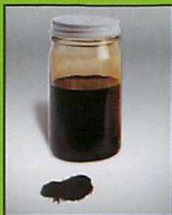
Fluido de dirección hidráulica sucio
